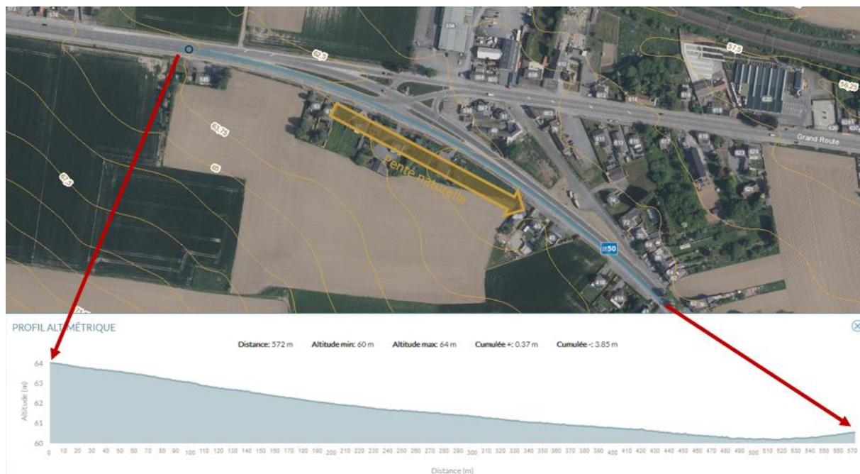
Figure 5 - Profil altimétrique de la chaussée de Mons, d'ouest en est.
